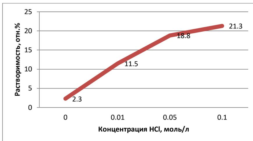
Рисунок 13. Зависимость растворимости серпентинита (серой пробы) от концентрации HCl
