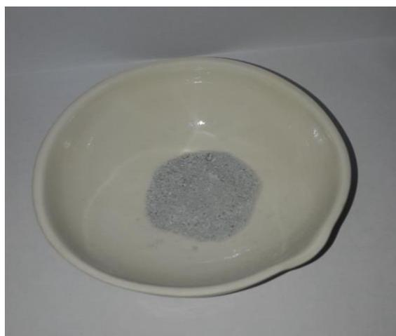
Рисунок 4. Серая проба: отходы производства асбестовых материалов на основе асбеста Кiemбаевского месторождения
